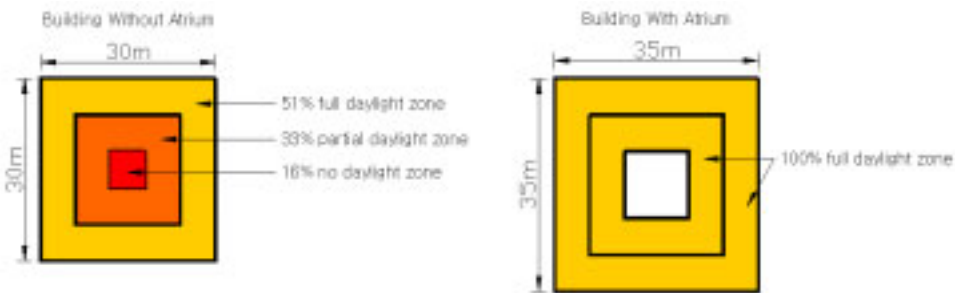
(그림 2.5) 아트리움을 이용한 자연채광 계획 개념
