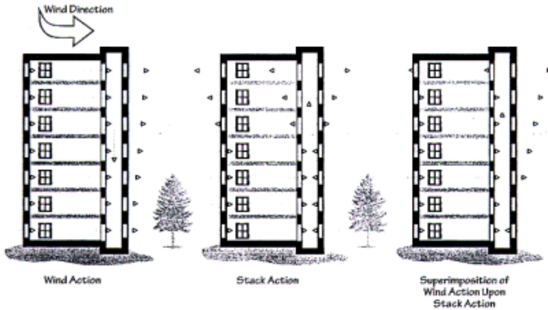
그림 12 Superimposition of Flows Due to Wind and Stack Actions
