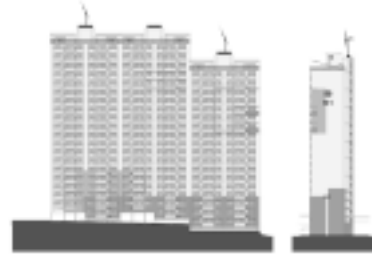
그림 8. 20층 옥상에 설치된 풍력발전기 입면(10 KW)
