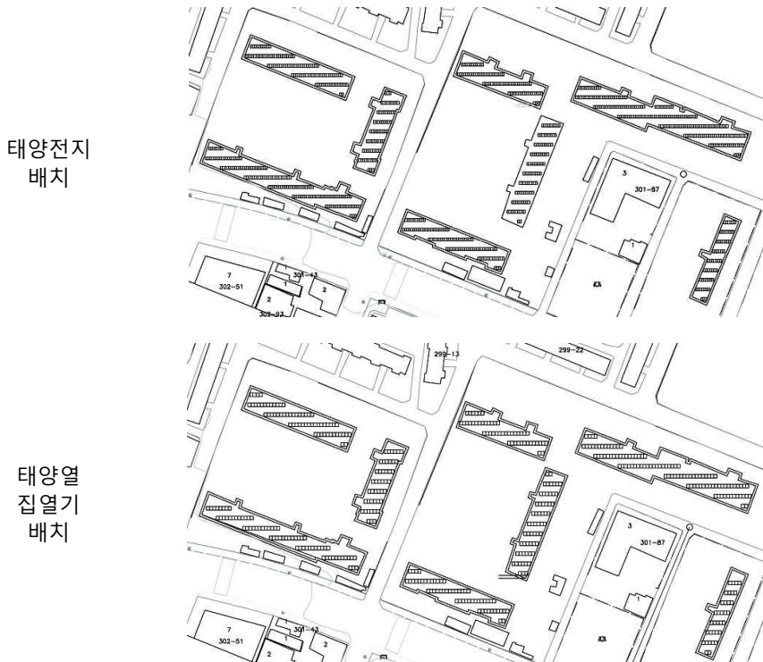
(그림 4.12) 공동주택단지의 시스템 최대 적용 시 옥상면 시스템 배치
