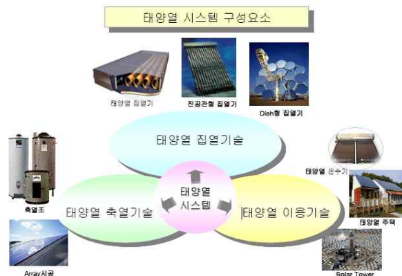
(그림 2.9) 태양열 시스템 구성요소
