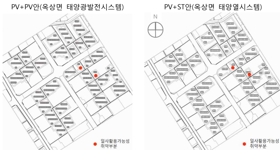
(그림 4.10) 저층단독주택단지의 시스템 최대 적용 시 옥상면 시스템 배치
