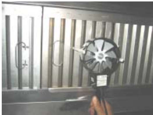
(그림 2.9) 4인치 회전풍속계를 이용한 필터표면의 풍속측정모습
