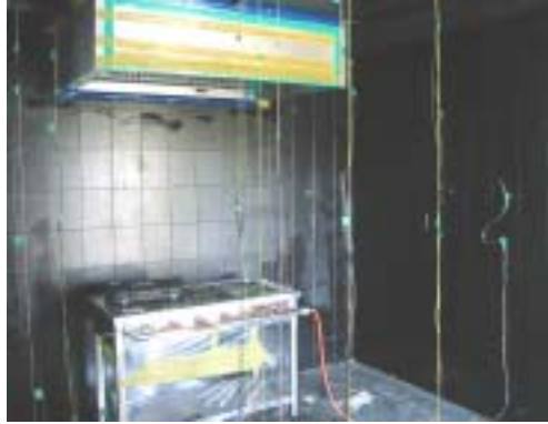
(그림 3.11) 실내 열전대 설치 모습
