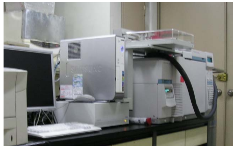
(그림 3.7) 기체크로마토그래피(GC-MSD)와 열탈착기(ATD)
