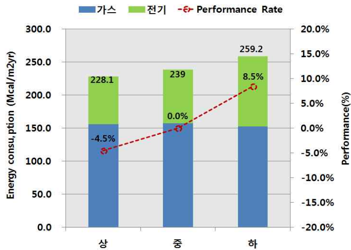
(그림 5.20) 조명기구 등급에 따른 냉·난방·조명부하 성능비교
