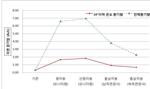
(그림 4.25) 지붕형태(환기창)별 전체환기량과 24°C이하온도 환기량
