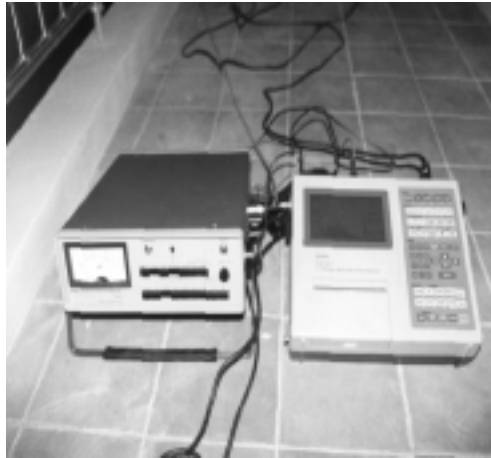
(사진 4.2) 분석기와 음원발생기 설치 전경
