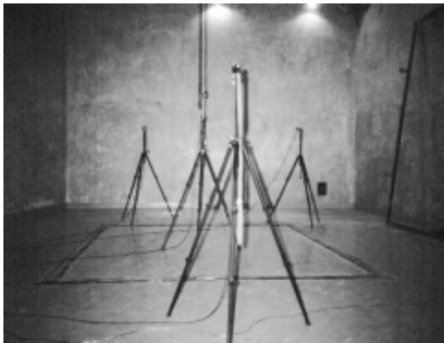
(사진 5.1) 잔향실내 마이크로폰의 설치
