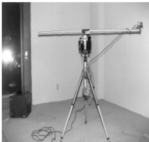
(사진 4.1) 벽체의 차음성능 측정 전경
